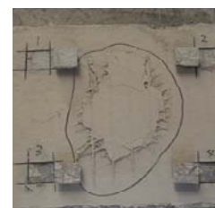
写真－2 付着強さの試験終了後の試験体
