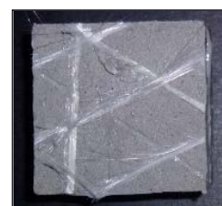
写真－1 ひび割れ抵抗性（左）と付着強さ（右）の試験終了後の試験体
