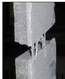
写真－1 ひび割れ抵抗性（左）と付着強さ（右）の試験終了後の試験体
