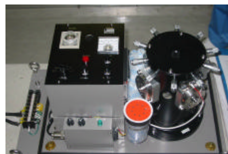
図3 機械式沿線地震計（内部）
