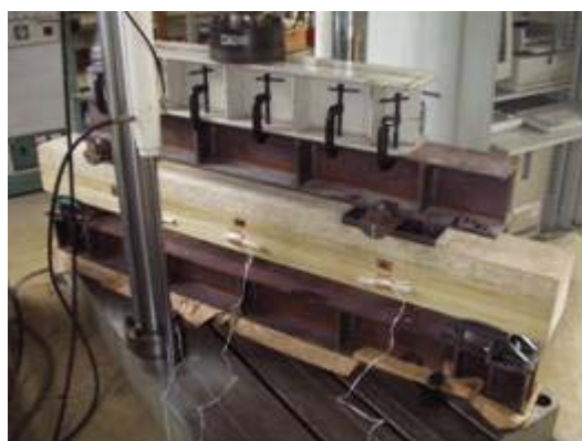
図3 改良形タイプの繰り返し曲げ試験の状況
