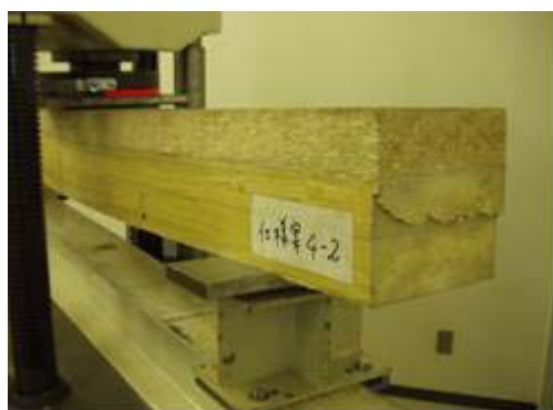
図4 曲げ破壊試験における破壊形態
