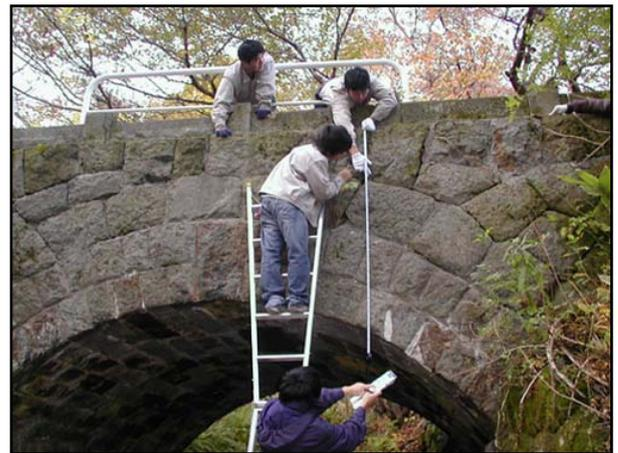
写真1 橋側面の石組み交点の計測作業
