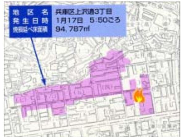
図-1 阪神大震災による松本通の延焼状況
