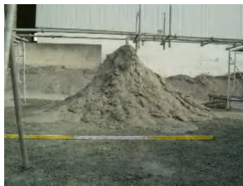
写真-1 勾配試験状況（配合1）
