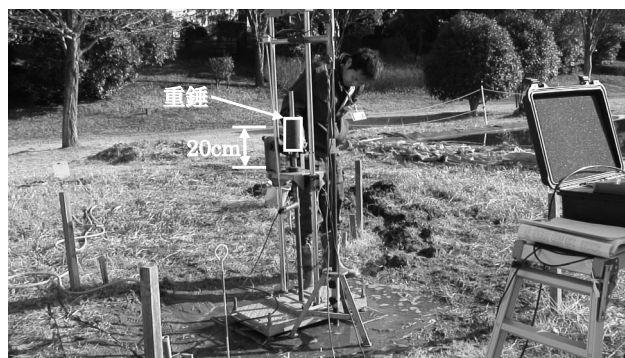
写真-3 打撃貫入装置及び試験実施状況
