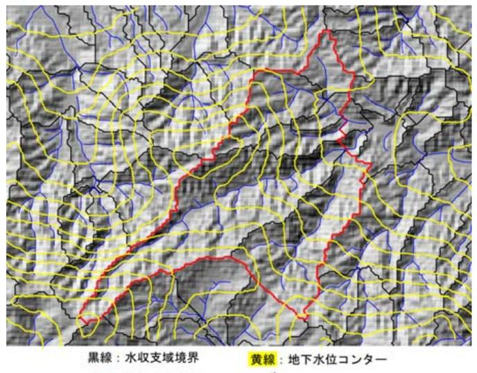
図-4 地形解析に基づく地下水位推定コンター
