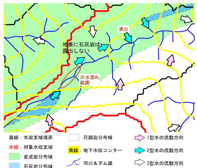
図-6 推定した地下水流動方向
