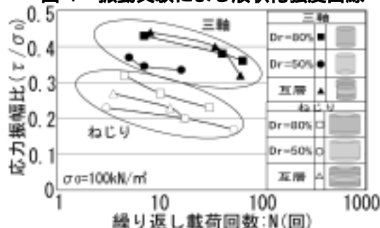
図-8 繰り返しせん断試験による液状化強度曲線
