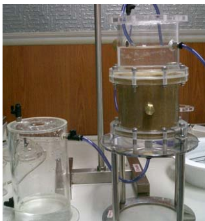
写真-1 カラムを利用した飽和透水試験
