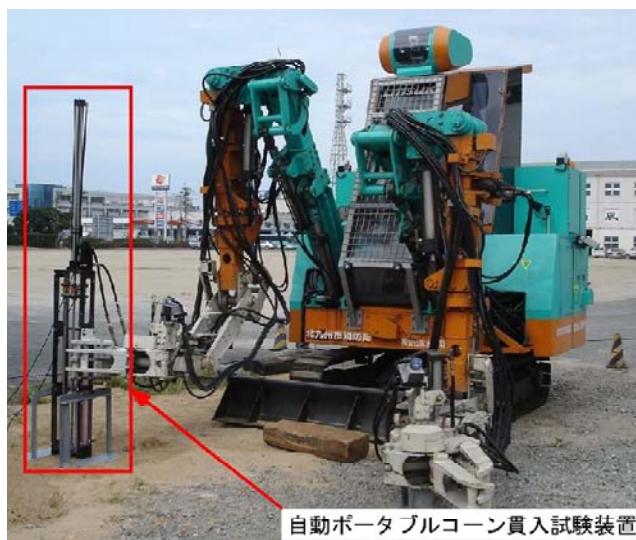
図-1. ロボットに装着した自動ポータブル貫入試験装置
