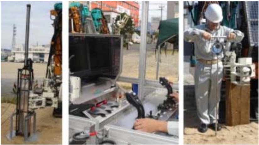
ロボット遠隔操縦による自動化ポータブルコーン貫入試験状況 有人による通常の試験状況 図-2. 自動ポータブルコーン貫入試験装置による現場実験状況
