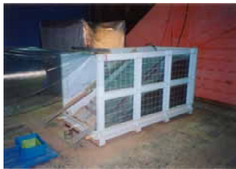
図 2 実験に使用した土槽と構築した模型盛土
