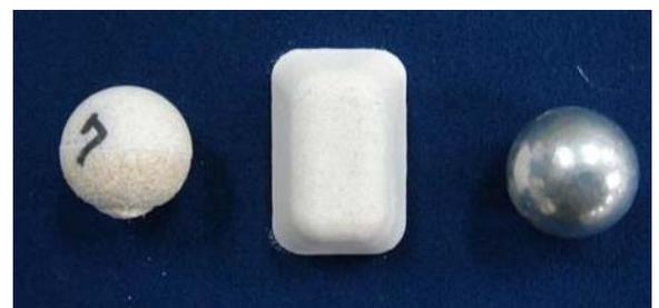
図-3 落石模型落石模型(左:石膏(25%)豊浦砂(75%)混合球, 中:石膏(25%)豊浦砂(75%)混合矩形, 右:アルミニウム球)
