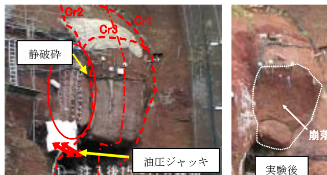
図1 対象岩塊と静破砕実験後（部分崩落）
