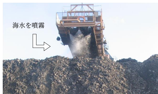
写真-1 リクレーマ船のスプレッダーでの加水状況
