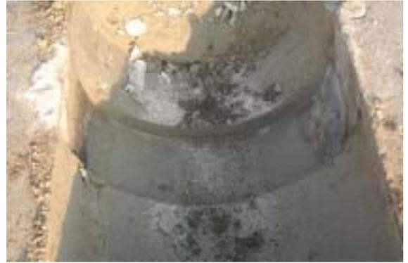
写真 - 1 円筒載荷後の変形パターン
