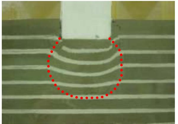
写真 - 2 密度の低い地盤内変形状況
