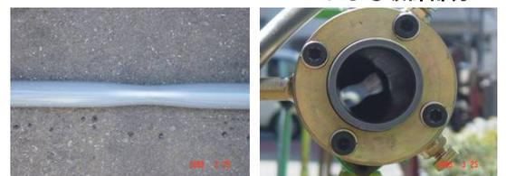
写真 3,4 VP40の外圧の変形
