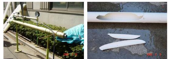
写真 1 外圧試験装置 写真 2 破碎埋設管の外圧による破碎部分
