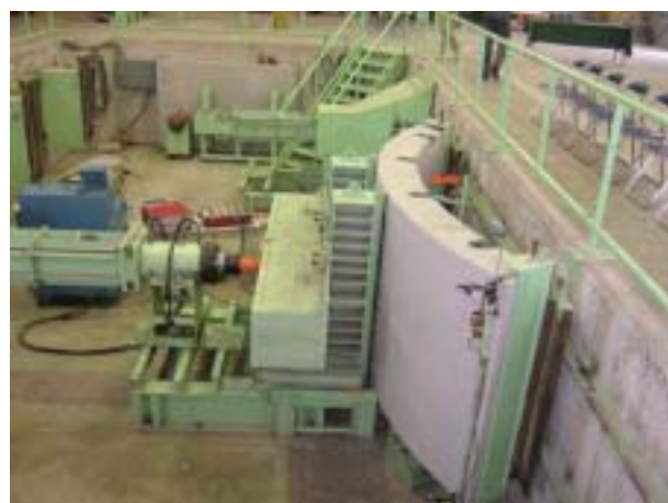
写真1 セグメントへの载荷状況
