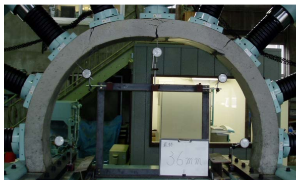
写真 2 ひび割れ・変形状況（最終押込み時）
