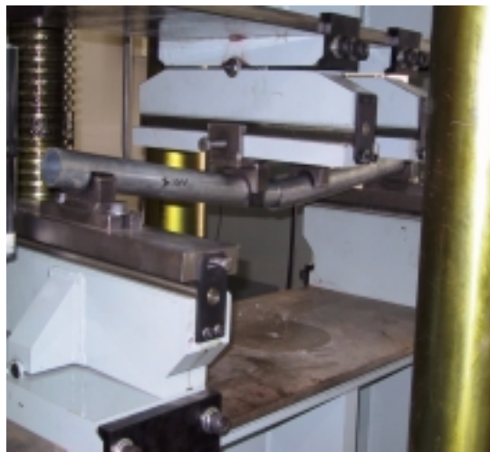
写真-1 载荷状況（2点曲げ载荷）
