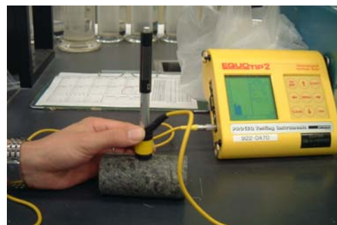
写真-1 エコーチップ試験機と試験状況
