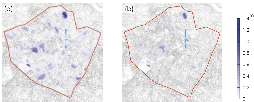
図-3 降雨開始 60 分後の浸水深コンター図の比較： (a) 下水道を考慮していない解析結果，(b) 下水道を考慮した解析結果
