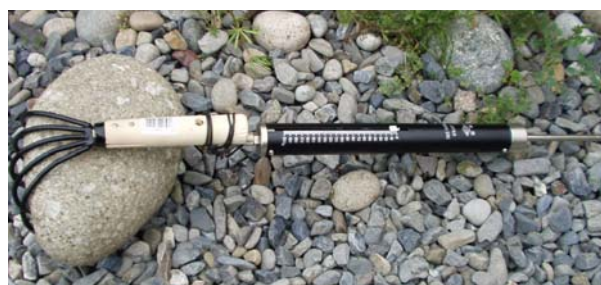
写真-1 河床固化の測定装置。ばねばかり（置針式丸型テンションゲージ、(株)大場計器製作所製）と熊手にて作成。
