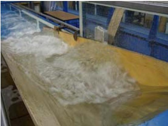
写真1 半台形断面魚道の流況
