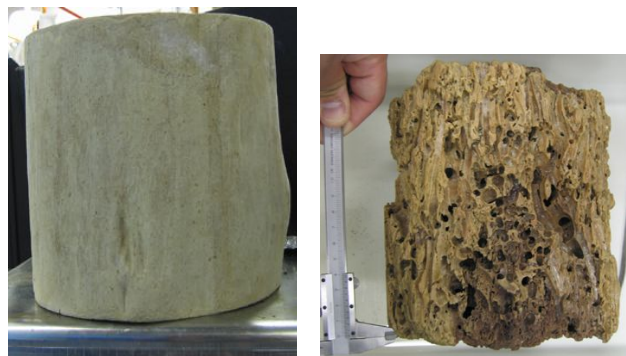
写真 沈設から 8 ヶ月後に回収した木材（右） 沈設から 33 ヶ月後に回収した木材（左）
