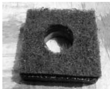
図-1 アスファルトマット移植基盤
