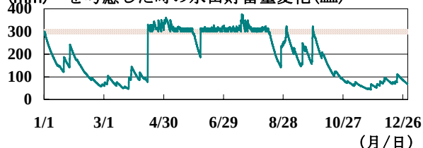
図4.2 圃場容水量・蒸発効率を考慮した田貯留量変化
