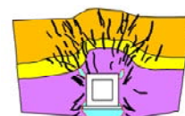
図-2 樋門周辺の変状の発達過程モデル
