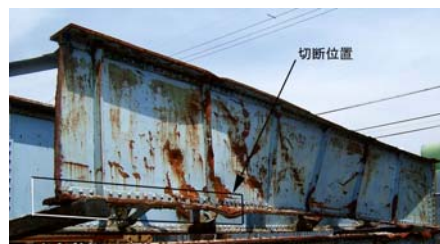
図.1 試験体に使用した桁
