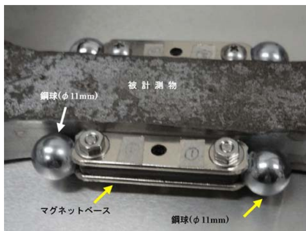
図-3 球体を使用した計測治具
