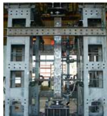
写真-1 圧縮実験
