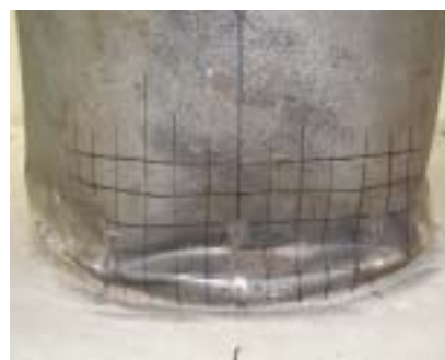
(a)A01 供試体（腐食が局所的）
