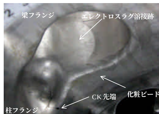
写真-3 ストップホールマクロ写真
