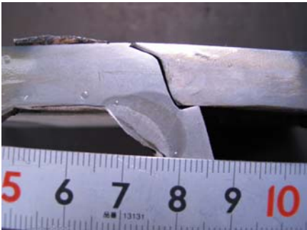
図1 無補強試験体で再現した疲労きれつ
