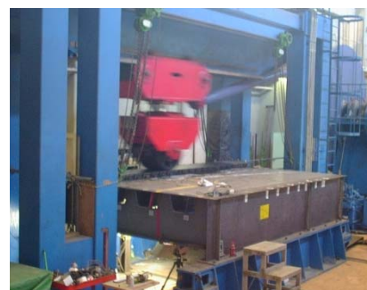
図2 輪荷重走行試験機
