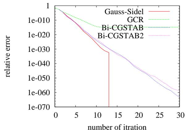
図 3: Gauss-seidel 法、GCR 法、Bi-CGSTAB 法、Bi-CGSTAB2 法の収束グラフの比較
