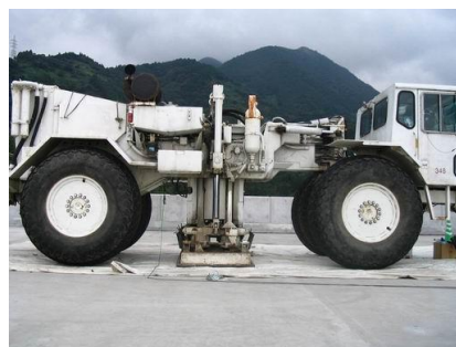
写真-1 起振車による振動実験
