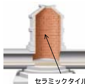
図-1 補修されたマンホール
