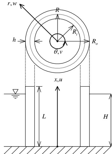
図-1 解析モデル、円筒座標系および変位方向
