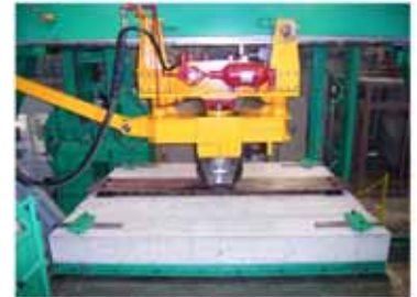
写真 - 2 輪荷重走行試験状況
