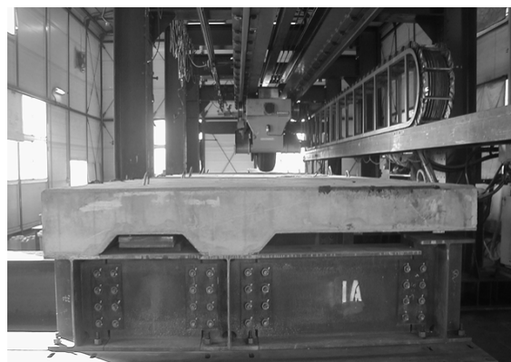
写真-1 張出し部の輪荷重走行試験の試験体
