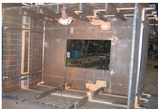
図1 溶接残留応力データを採取した箱桁
