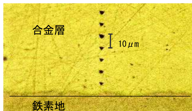
写真-3 硬さ試験後の合金層の圧痕跡
