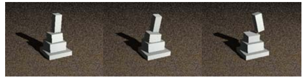
図3 和型 W0101 の挙動の再現(左から 13, 14, 15 秒後)
