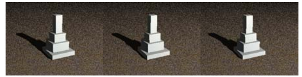
図4 和型 W0102 の挙動の再現(左から 15, 17.5, 20 秒後)
