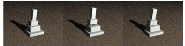
図5 和型 W0103 の挙動の再現(左から 12.5, 15, 17.5 秒後)
