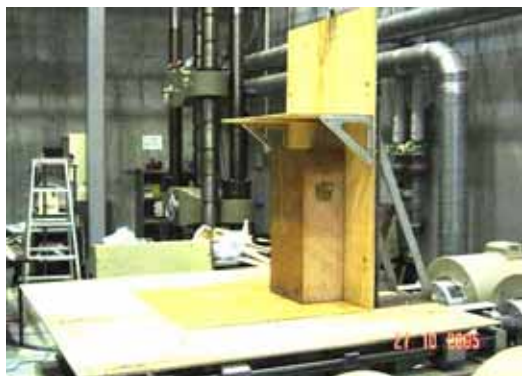
図1 木製ブロックを用いた振動台実験の様子
