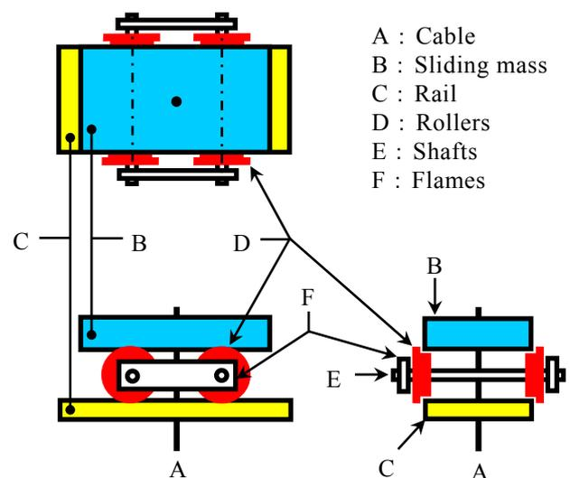
図2 運動体の基本構造
