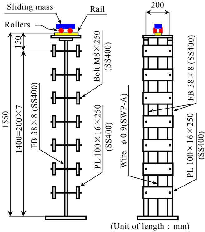
図3 構造物模型の一般図
