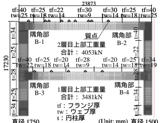
図-2 橋脚Bの形状および板厚分布状況
