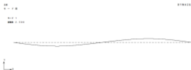
図—4 1次モード(2.5Hz)のモード形状
