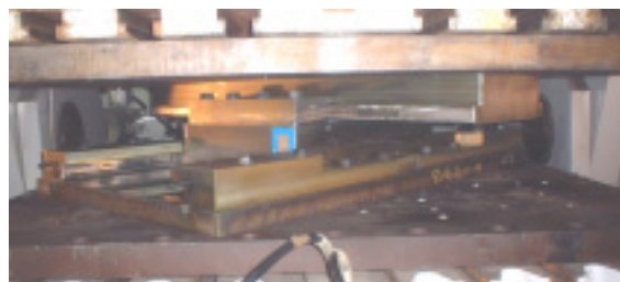
写真-1 試験体設置状況(45°加振試験時)
