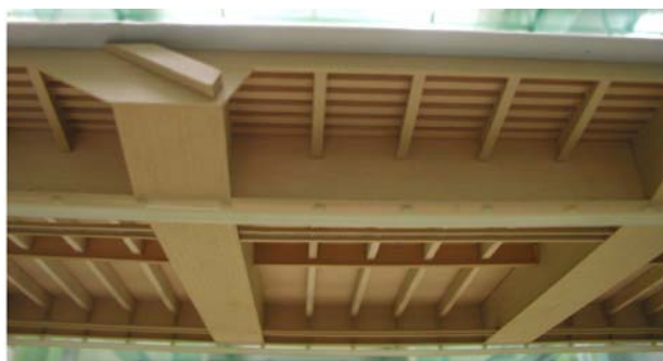
写真-1 風洞模型(主桁内+張出板)
